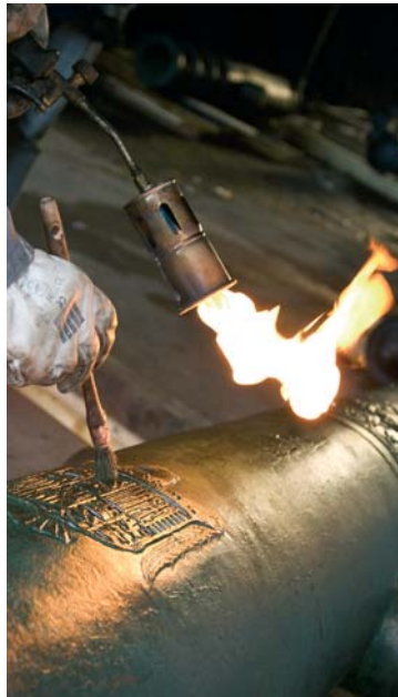
Restauration d'un canon : application à chaud de la cire microcristalline par un restaurateur spécialisé.
