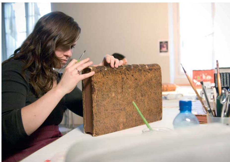
Réparation des livres : la technicienne effectue de petites réparations : renfort des coins et coiffes, sur un ouvrage plein cuir.
