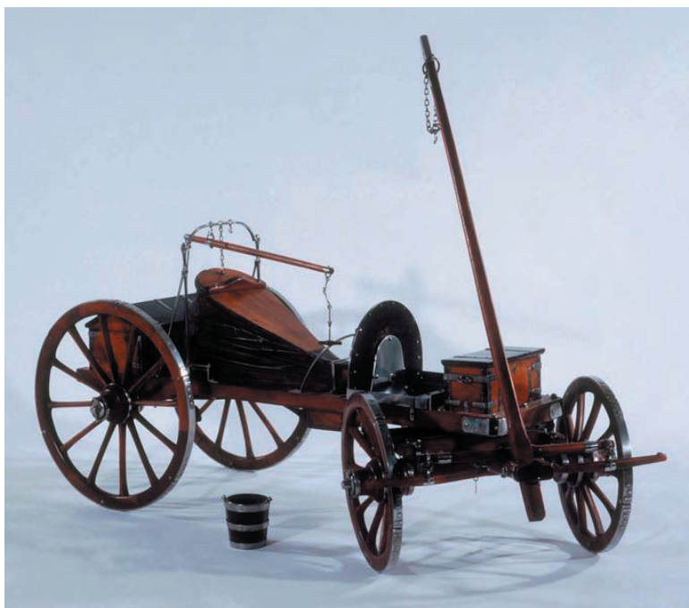
Modèle réduit de chariot-forge de campagne, modèle 1770 modifié 1808, à l'échelle 1/4. Inv.: O 204 © Paris, Musée de l'Armée/RMN-GP 06-516472
