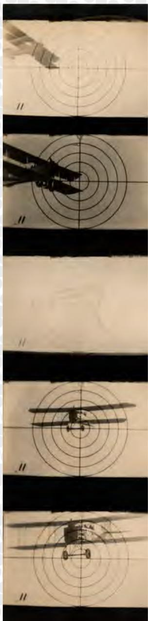
Bande de photographies réalisées avec la Camera gun Thornton-Pickard Mark III «Hythe» camera
